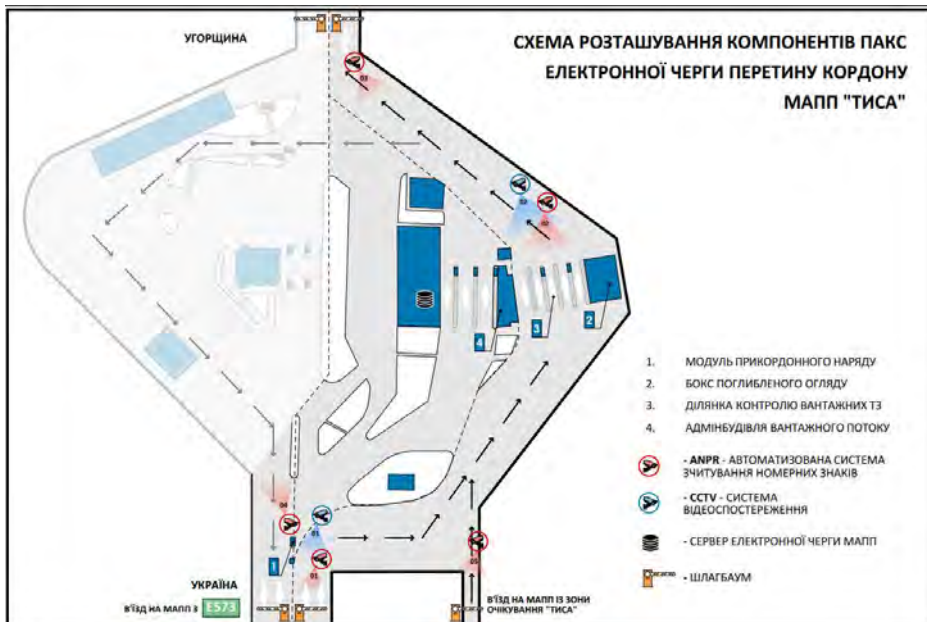
Рис. 4.18. Схема розташування компонентів програмно-апаратного комплексу електронної черги перетину кордону МАПП «Чоп (Тиса)»
